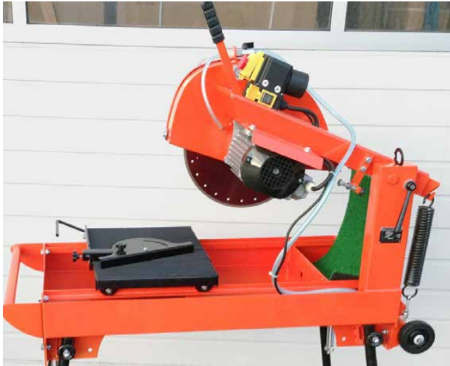
Bild 10: Steintrennmaschine mit geschlossener Diamant-Trennscheibe
